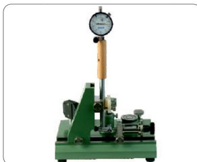
проверка точности нутромеров с круговой шкалой (диапазон 6-450 мм)
