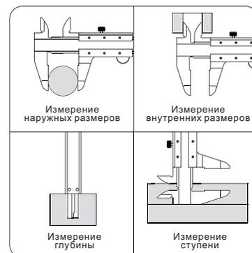
Измерение наружных размеров
