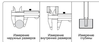
Измерение наружных размеров
