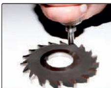
Измерение твердости небольших изделий
