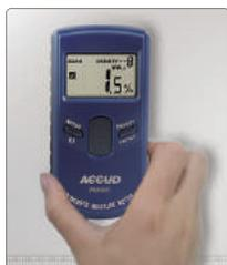
Измерение влажности бетона
