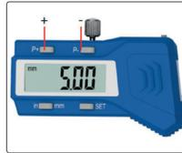
измерение расстояния от края до центра отверстия
