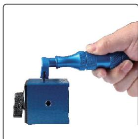
шаг 1: нанесите поперечную насечку на поверхность
