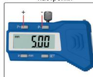
Измерение расстояния от края до центра отверстия
