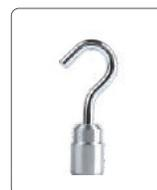
насадка для испытания на растяжение
