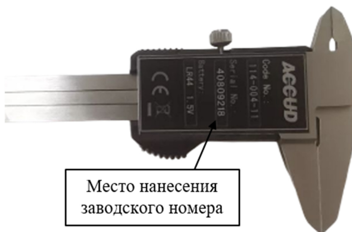
Рисунок 28 – Место нанесения заводского номера на штангенциркули модификации 114
