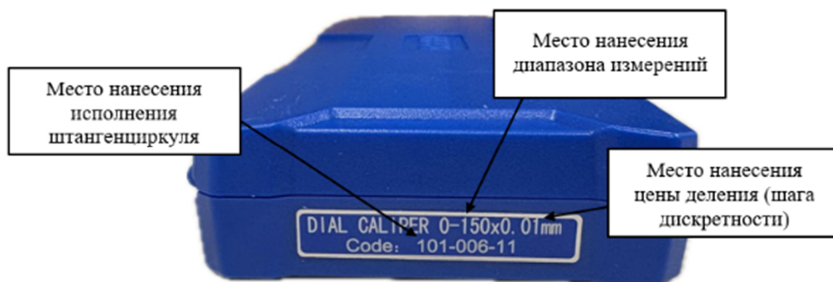
Рисунок 31 – Общий вид шильда с указанием мест нанесения исполнения штангенциркуля, диапазона измерений и цены деления (шага дискретности)
