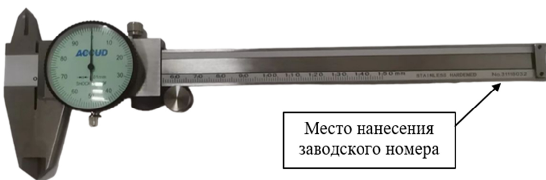
Рисунок 30 – Место нанесения заводского номера на штангенциркули модификаций 101, 103
